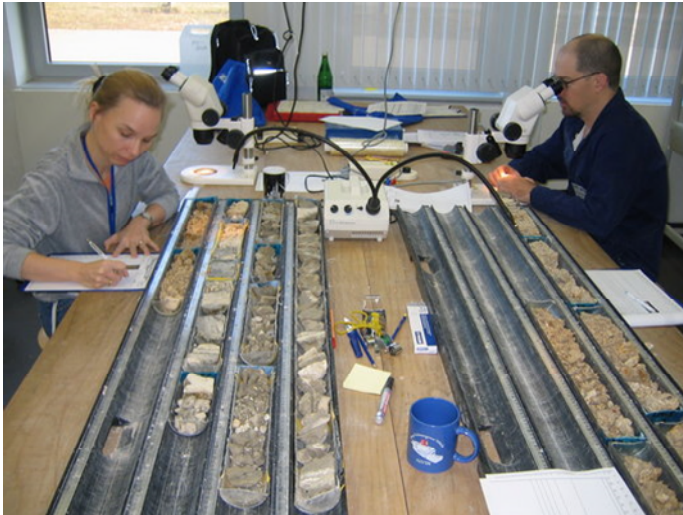
GeologInnen dokumentieren Gesteinsanalysen an Bohrmaterial
