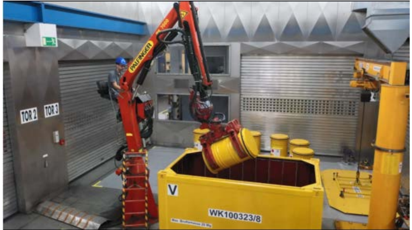
Verpacken von Fässern in Konrad-Container
