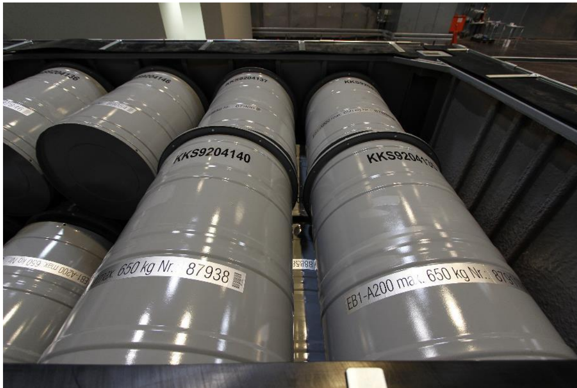
Einlegen von Abfallfässern in Konrad-Container durch den Abfallerzeuger/Konditionierer (Quelle PEL)
