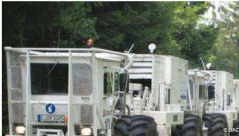
Eine Gruppe von Vibrations-Trucks während einer seismischen Messung.
