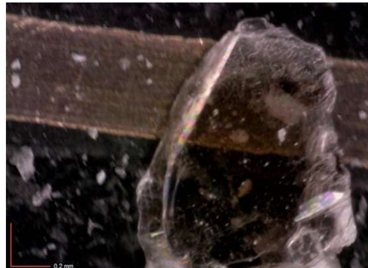
Biotit aus Bohrkern eines Orthogneises
